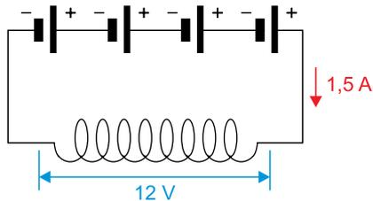
Nesse circuito, a diferença de potencial que se estabelece entre as extremidades do condutor é de 12 V e a intensidade da corrente elétrica que o atravessa é de 1,5 A.
